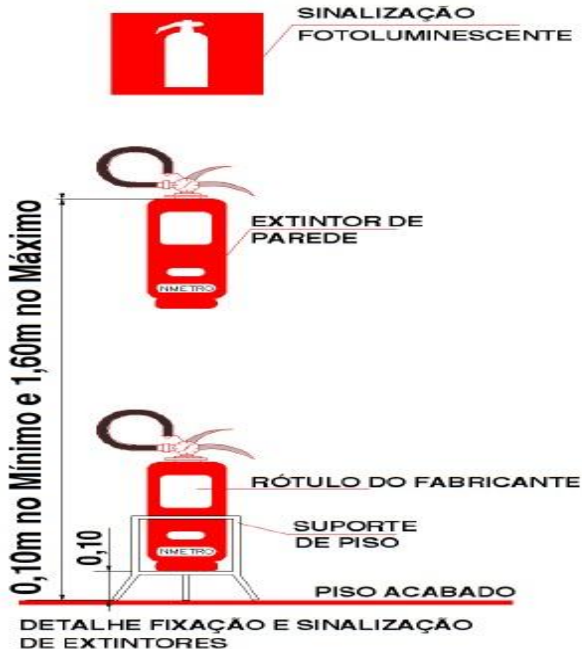
Figura 1 - Fixação de extintor
