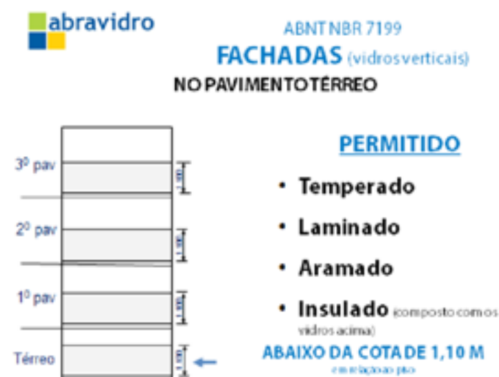
Figura 27 – Aplicação de vidros de segurança abaixo de 1,10m (Imagem cedida pela Abravidro)
