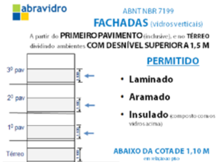
Figura 29 – Aplicação de vidros de segurança abaixo de 1,10m, a partir do primeiro pavimento (Imagem cedida pela Abravidro)
