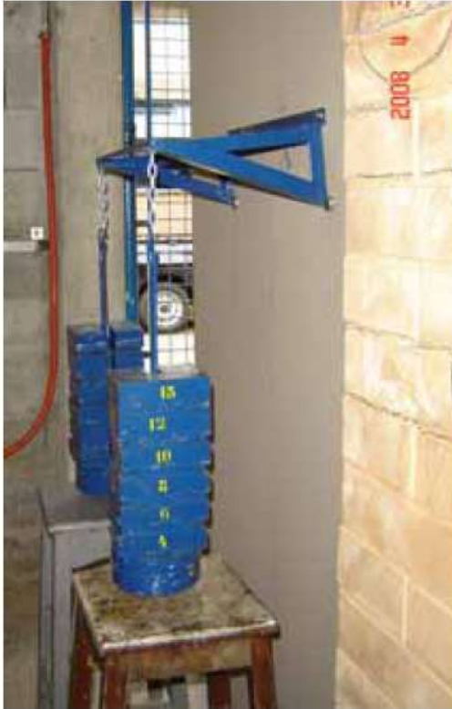
: Vista lateral da parede após carregamento de 785 N (80 kgf).
