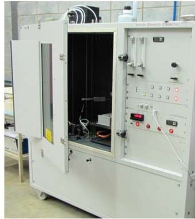
Figura 9 – Equipamentos para ensaios de ignitibilidade, propagação superficial de chamas e densidade óptica de fumaça (Fonte: IPT)
