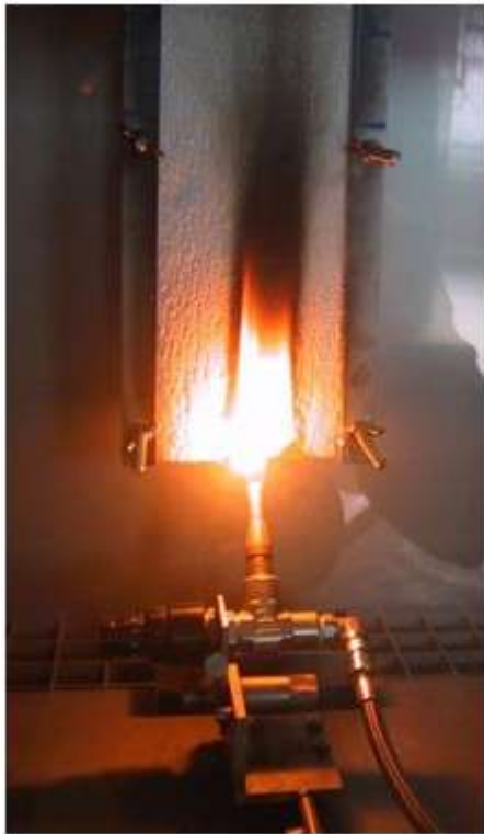
Figura 9 – Equipamentos para ensaios de ignitibilidade, propagação superficial de chamas e densidade óptica de fumaça (Fonte: IPT)
