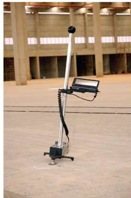
Figura - Equipamento para medição dos F-Numbers (dipstick)
