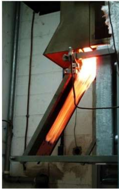
Figura 9 – Equipamentos para ensaios de ignitibilidade, propagação superficial de chamas e densidade óptica de fumaça (Fonte: IPT)
