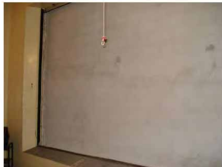
Figura 2 – Parede na câmara reverberante, para o teste de isolamento sonora.
