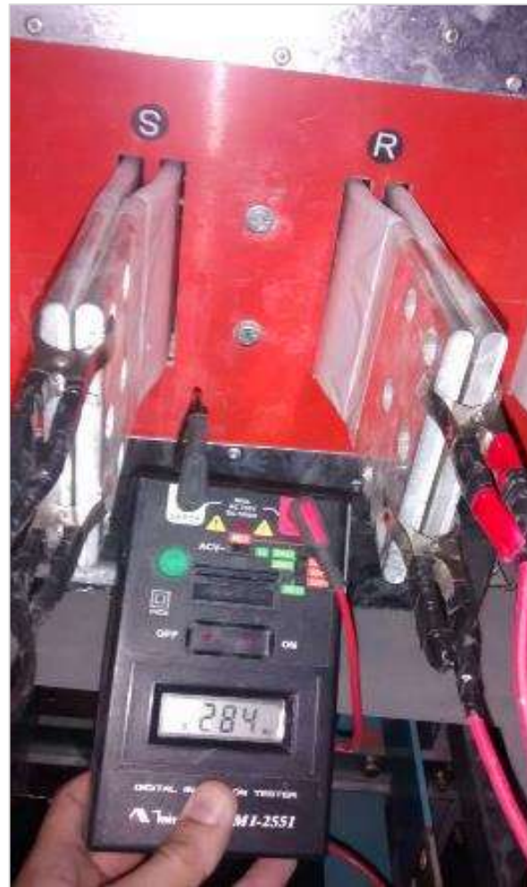
Teste de busway com o uso do Megômetro
