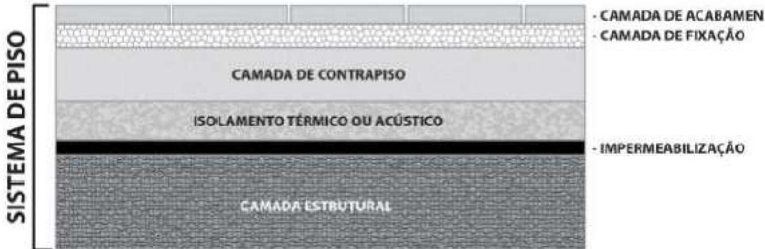
Figura 1 — Exemplo genérico de um sistema de pisos e seus elementos
