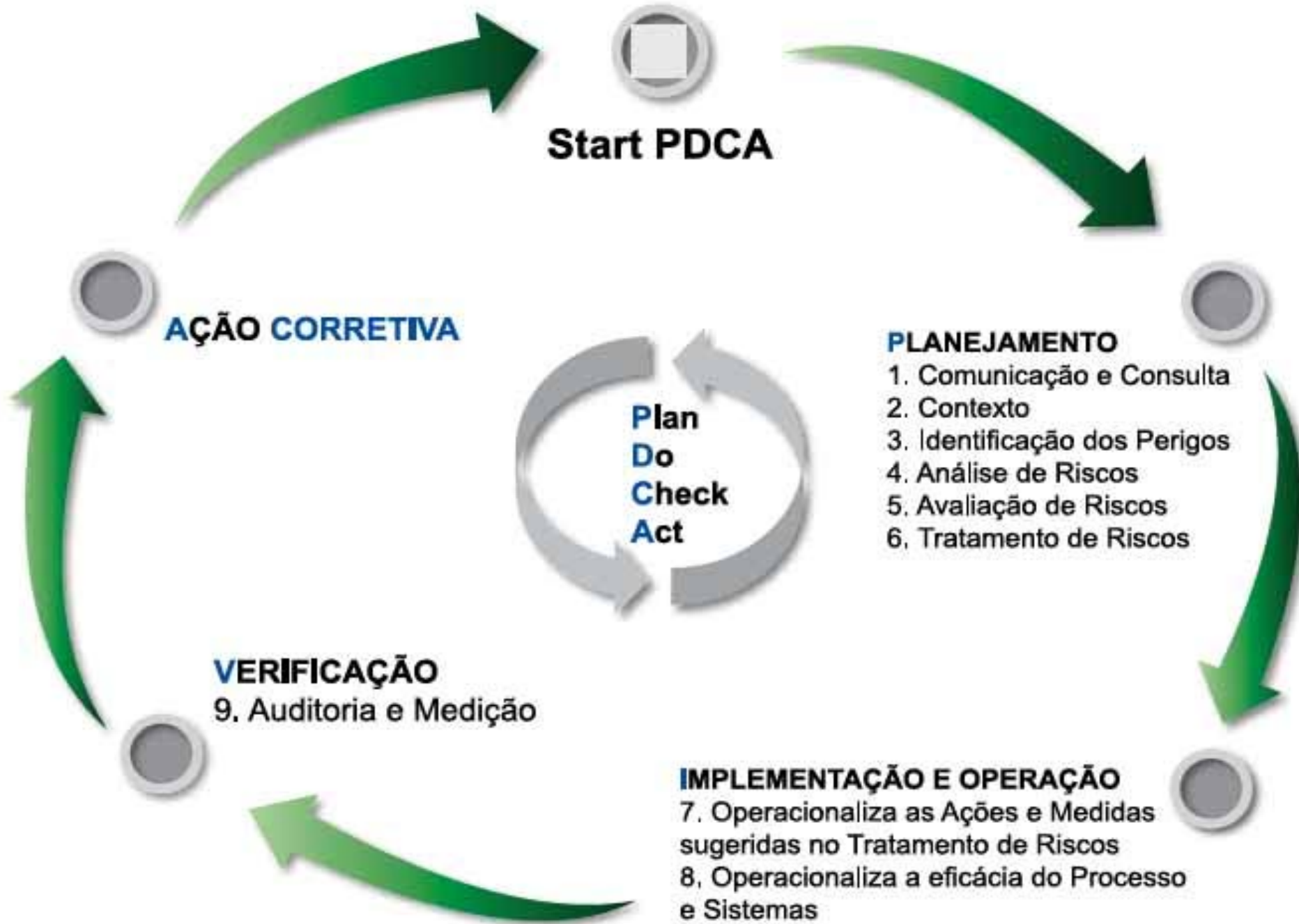
Ciclo PDCA x Fases de Gestão e Análise de riscos do Método Brasileiro
