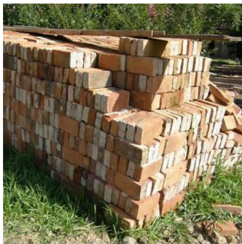
Tijolos de demolição
